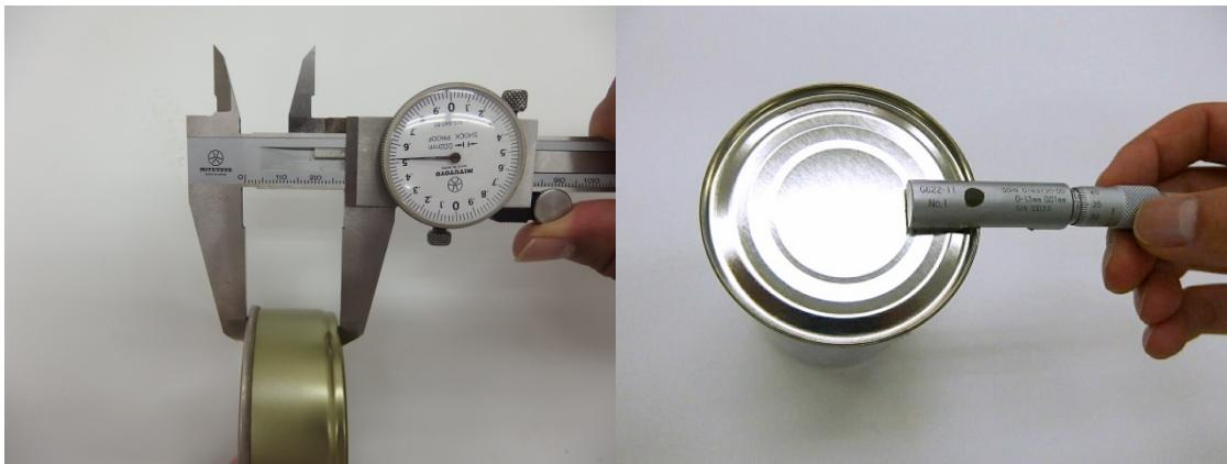
写真6 外部寸法測定
