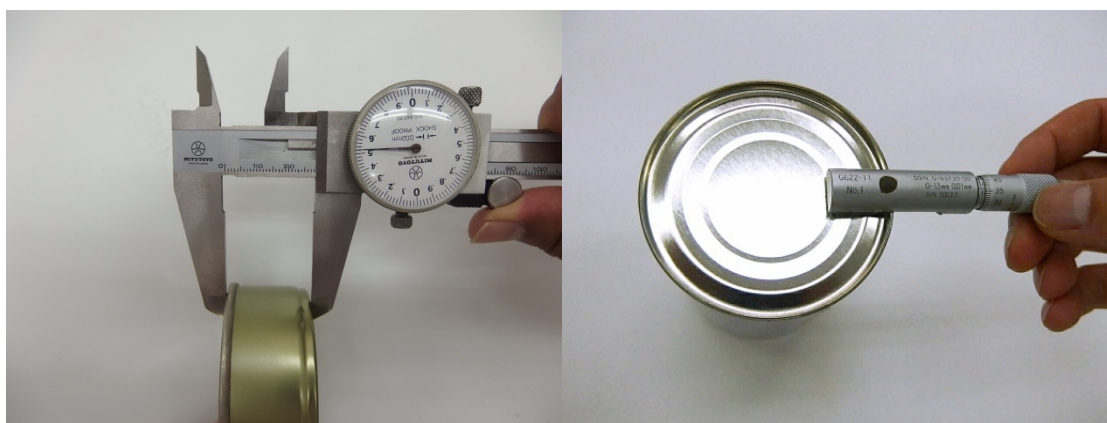
写真 6 外部寸法測定
