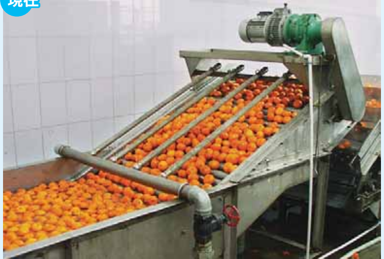
原料送果(原料投入のショックを緩和するため、原料を水槽に投入してコンベヤーで送果する)
